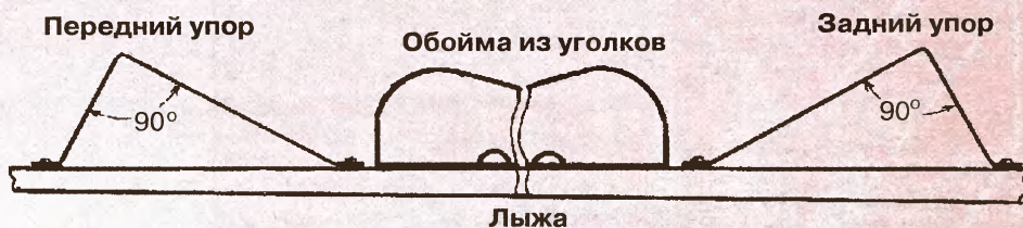
Рис. 2. Расположение деталей крепления на лыже.
