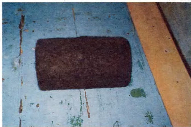
Фото 7. Скатанный вот в такой рулон валенок катается мастером в горячей воде.
