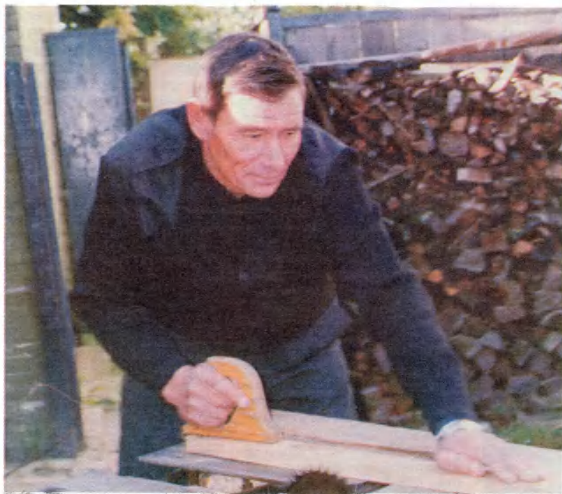
Применение ручки-подталкивателя при обработке пиломатериала
